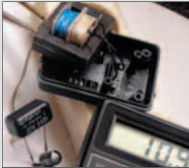
Фото 8. Замер напруги на трансe
